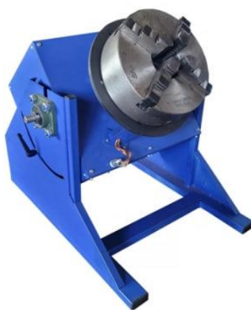
Рисунок 2.6 – Позиціонер–обертач для зварювання Tesla Weld ТПГ ПОЗ–300 [37]
