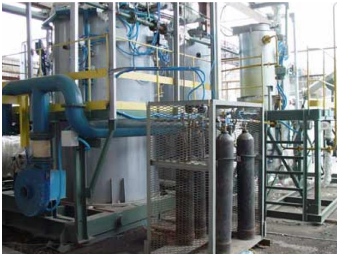
Рис. 1.3.1 Установа для одержання водню конверсією природного газу
