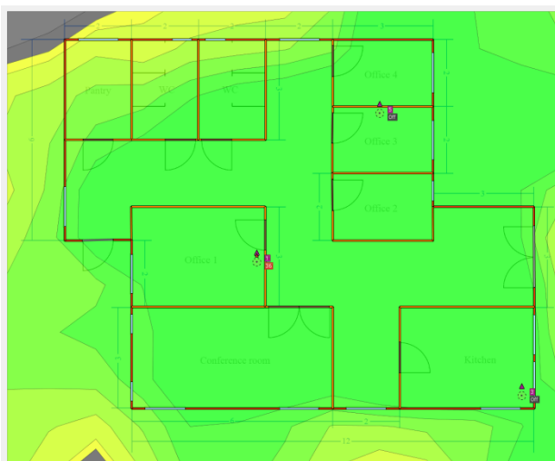
Рисунок 4.5 – Рівень сигналу на частоті 2,4 ГГц
