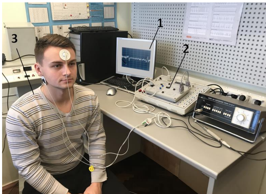
Рис. 3.15. Проведення вимірювання ЕЕГ людини: 1 – персональний комп'ютер; 2 – система для біометричних вимірювань KL-720; 3 – пацієнт.
