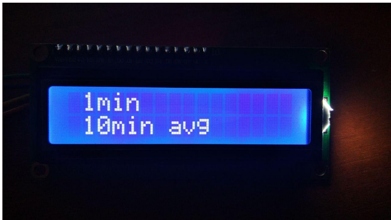
Рисунок 3.13 – Інформаційне повідомлення, яке з'являється при підключенні приладу до живлення
