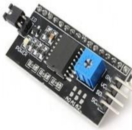
Рисунок 3.7 – Зовнішній вигляд перехідника інтерфейсу I2C
