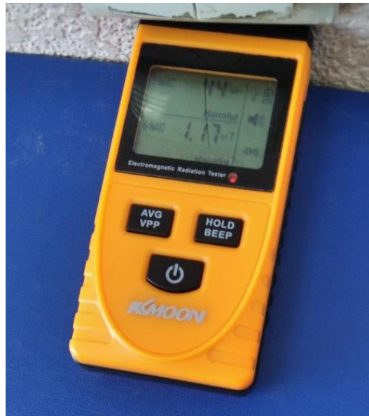
Рисунок 3.18 – Зняття показів з еталонного індикатору ЕМП
