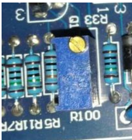
Рисунок 3.16 – Потенціометр R100 на платі детектора іонізуючого випромінювання
