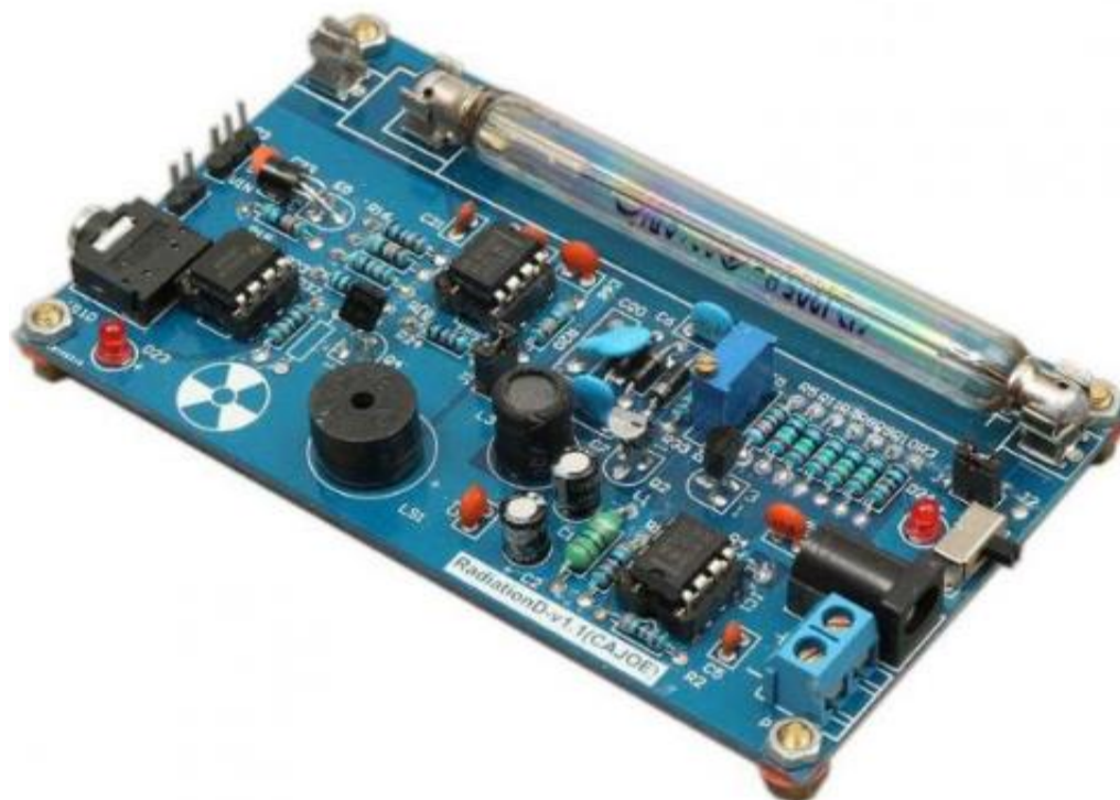
Рисунок 3.9 – Зовнішній вигляд детектора іонізуючого випромінювання Характеристики трубки Гейгера-Мюллера (рис. 3.10) наведено в табл. 3.10
