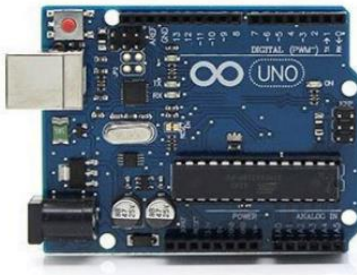
Рисунок 3.6 – Зовнішній вигляд плати ArduinoUno
