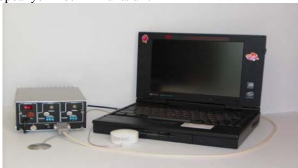
Рисунок 2 – Комплекс виброакустической защиты речевой информации ОЦЗИ-ВА
