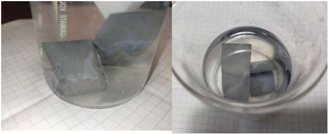
Рисунок 3.7 – Фото зразків з осаджени цинковим покриттям, через 5 днів після початку випробування.
