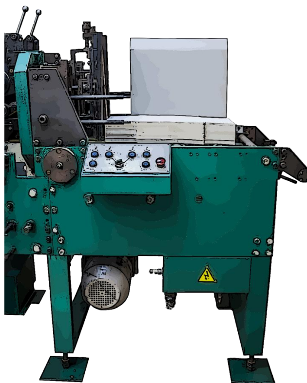
Рис. 4.2.1. Механізм самонакладу експериментальної лінії по виготовленню напівжорстких обкладинок
