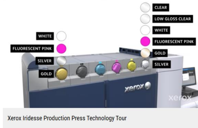
Рис.- 2.2. Станції розміщення тонеру у друкарській машині Xerox Iridesse Production Press [9].
