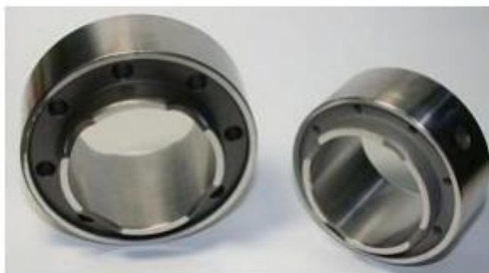
Рисунок 1.11 – Два оброблених литих підшипника \text{Co}_{1.5}\text{CrFeNi}_{1.5}\text{Ti}_{0.5} , виготовлених методом лиття. Зовнішній діаметр 56 мм і внутрішній діаметр 38 мм [1]
