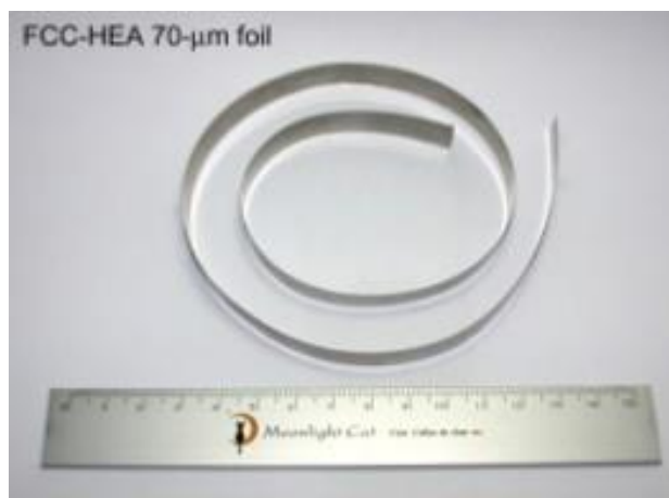
Рисунок 1.10 – Фольга товщиною 70 мкм, отримана методом дугового плавлення та холодної прокатки [1]
