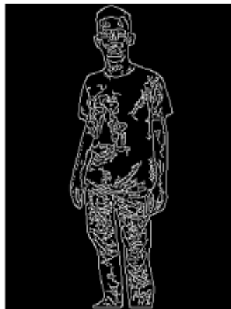
Рисунок 5.6 - Оригінальне зображення та з виявленими краями для оператора Canny
