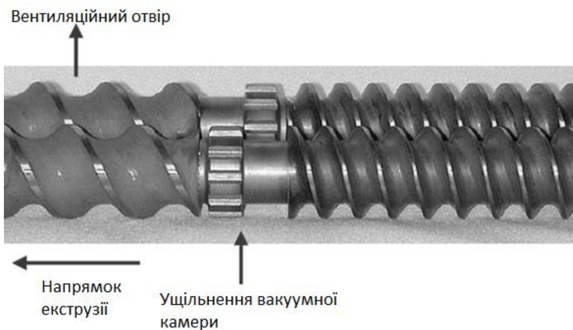
Рисунок 4.6 – Зображення черв'яків з ущільненнями для вакуумної камери [21]
