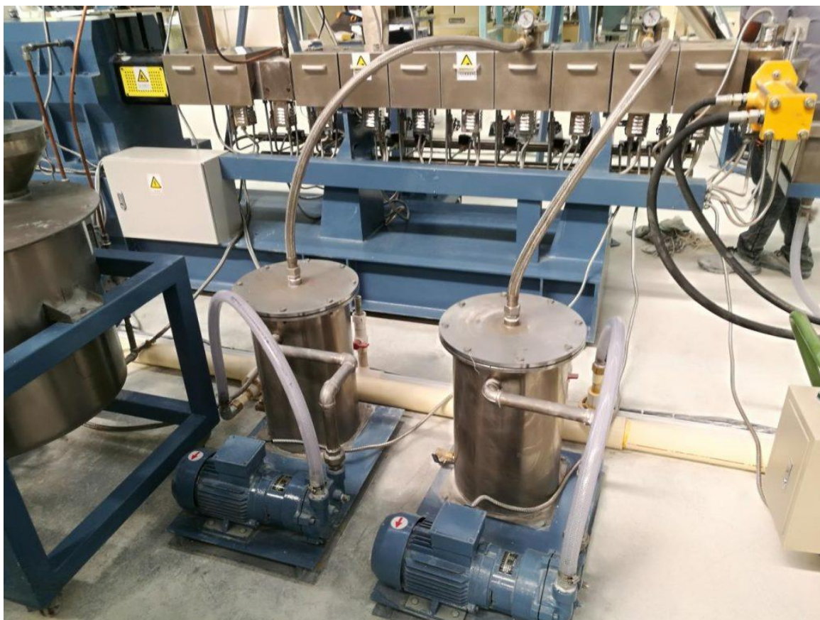
Рисунок 4.9 – Вакуумна система екструдера з буферною ємністю [23]
