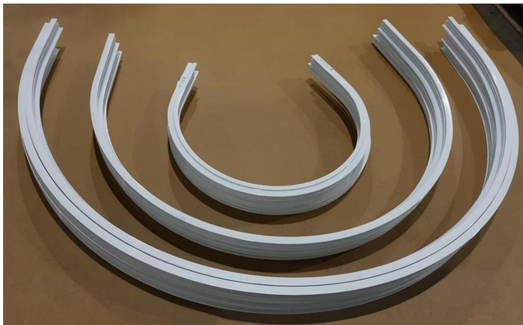
Рисунок 4.12 – Дефекти екструдованого матеріалу, деформація [28]
