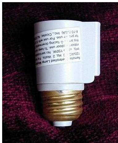
Рис.1.4. Модуль X10: модуль ламповий у вигляді патрона. [4]
