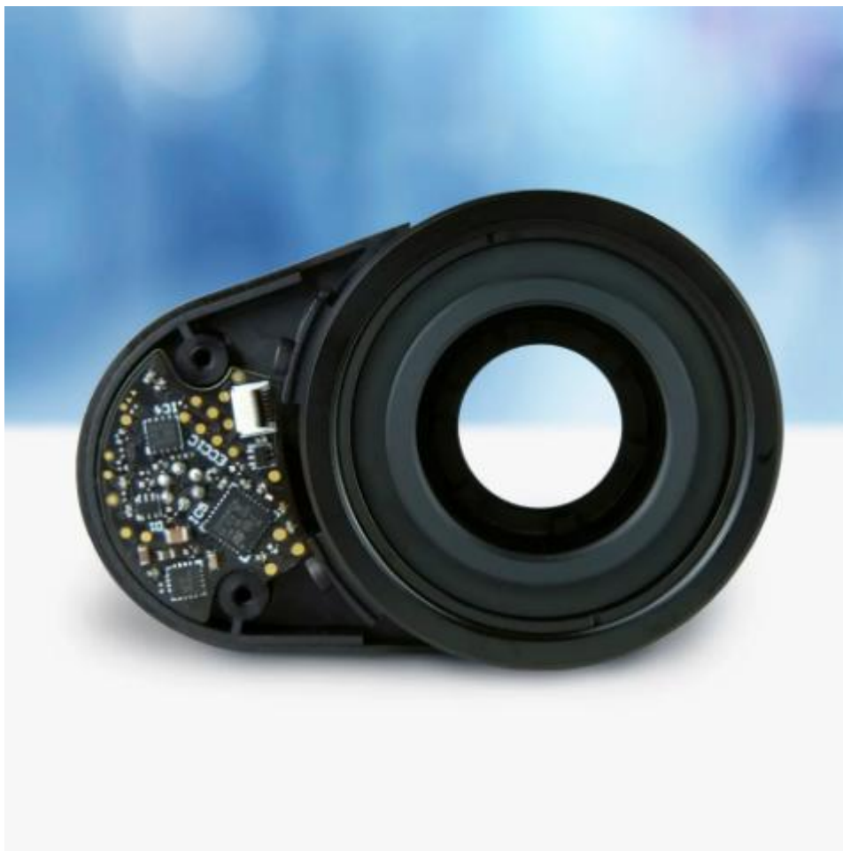
Рис. 1.7 - Варіолінза ECC-1C з вбудованим драйвером [14]
