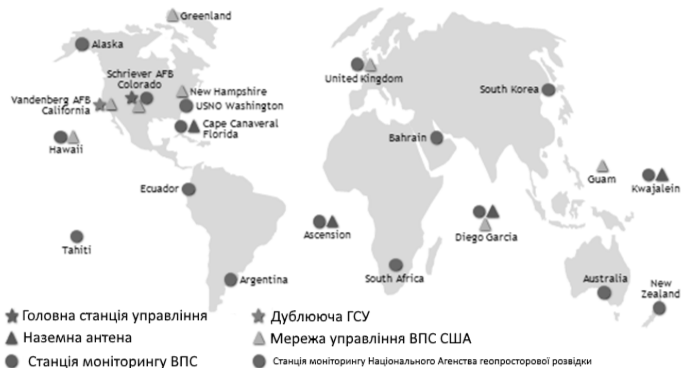
Рисунок 1.7 Розташування наземних компонентів геонавігаційної системи GPS
