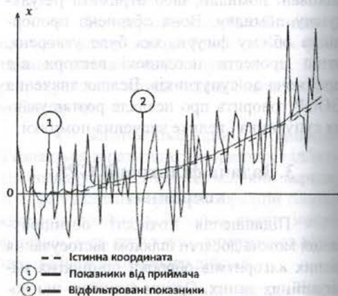
Рис. 2. Відфільтровані дані з імітаційного GPS приймача
