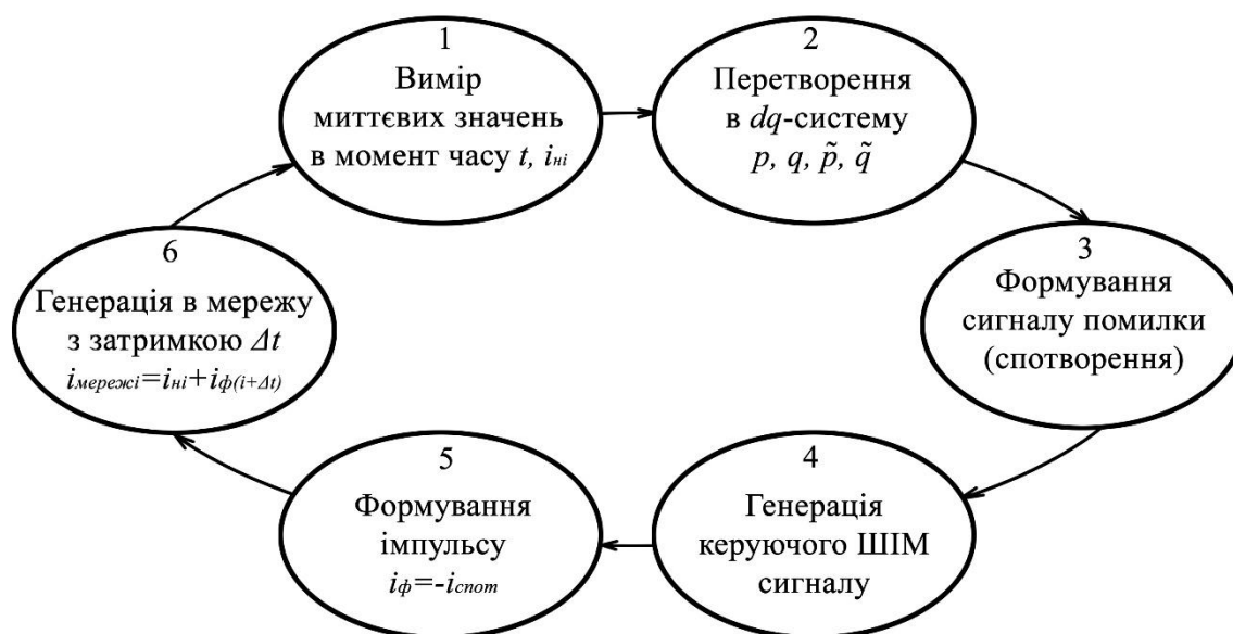
Рисунок 1.10 – Алгоритм роботи системи керування активним фільтром
