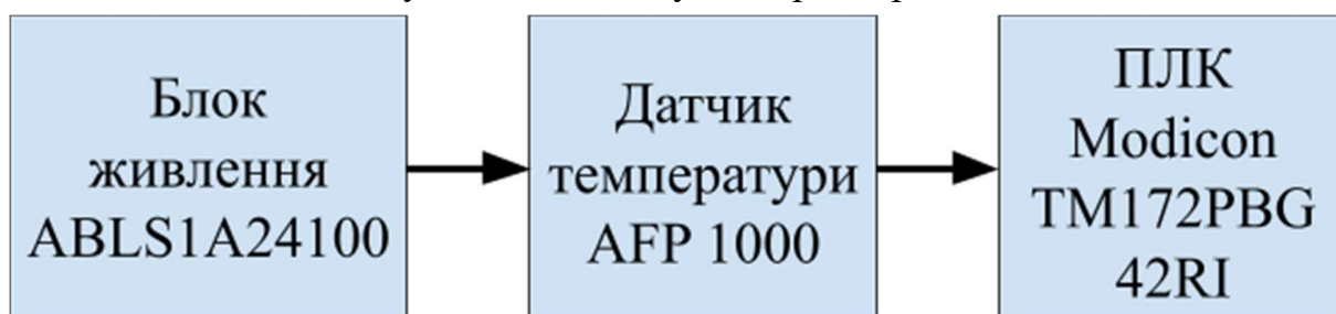
Рисунок 2.13 - Схема структурна надійності ВК температури повітря після калориферу
