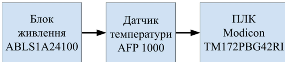
Рисунок 2.9 - Схема структурна надійності ВК температури повітря навколишнього середовища
