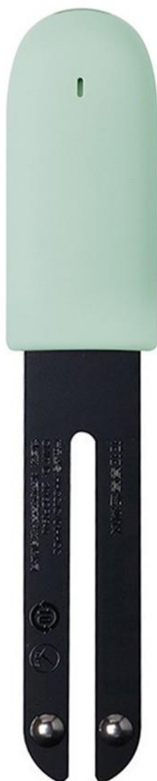
Рисунок 1.1 — Вигляд пристрою Flower Monitor [1]
