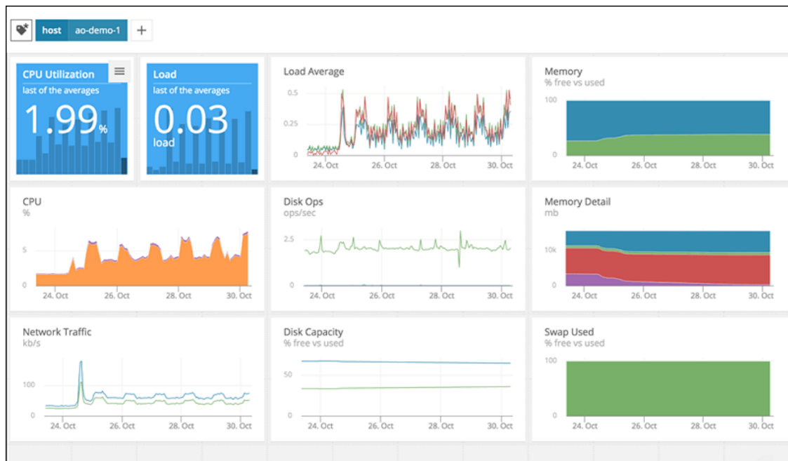
Рисунок 1.7 — Приклад панелі моніторингу ПЗ «AppOptics APM»
