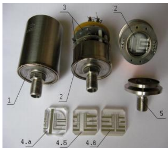
Рис.4.12. Конструкція датчика тиску 2SP: 1 – перетворювач у корпусі; 2 – вузол чутливого елемента; 3 – електронні плати; 4 – кварцовий мембранний чутливий елемент (варіанти); 5 – штуцер
