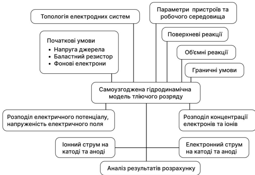
Рисунок 3.2 Фізико-топологічна модель тліючого розряду
