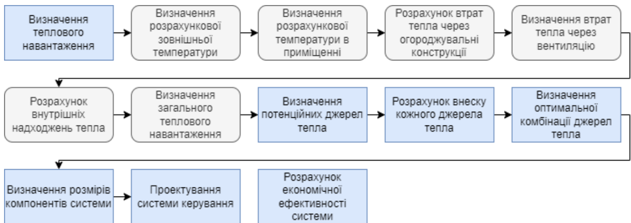
Рисунок 2.1 – Алгоритм розрахунку гібридних систем для потреб теплозабезпечення
