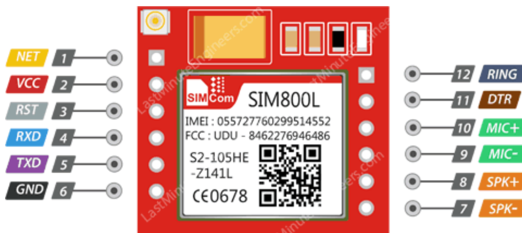
Рисунок 5.8 – Модуль SIM800L піни
