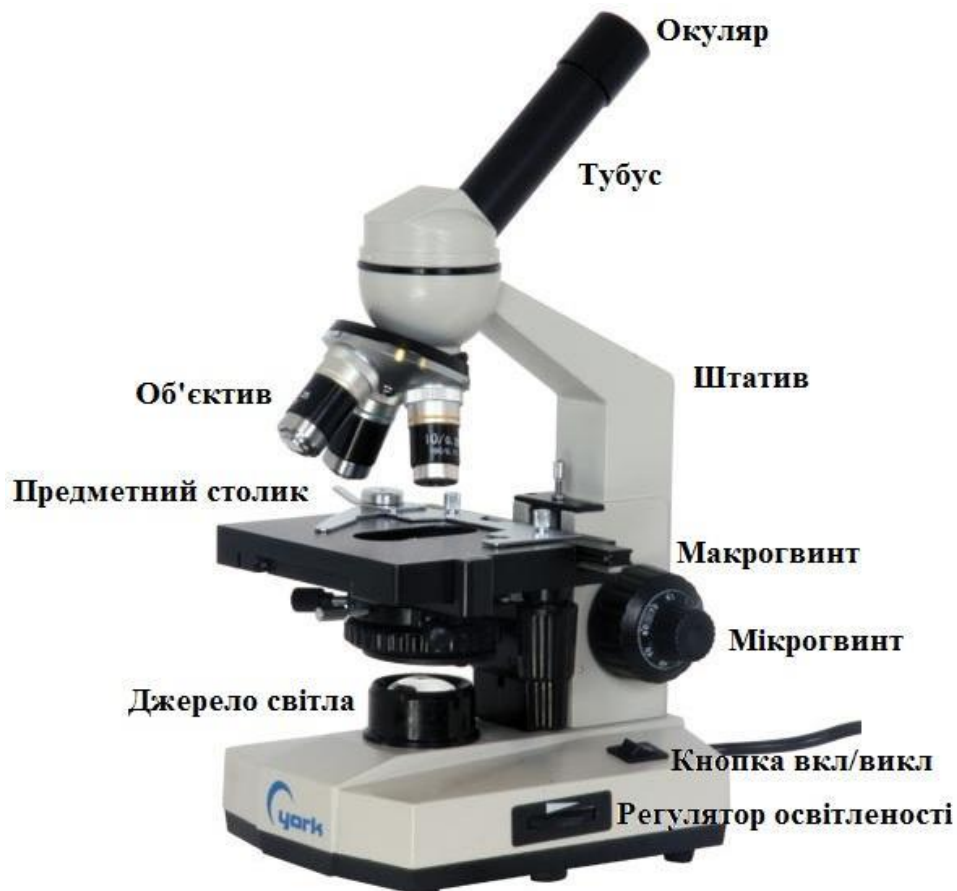
Рис 1.2 – Приклад світлового мікроскопу та його компоненти [4]
