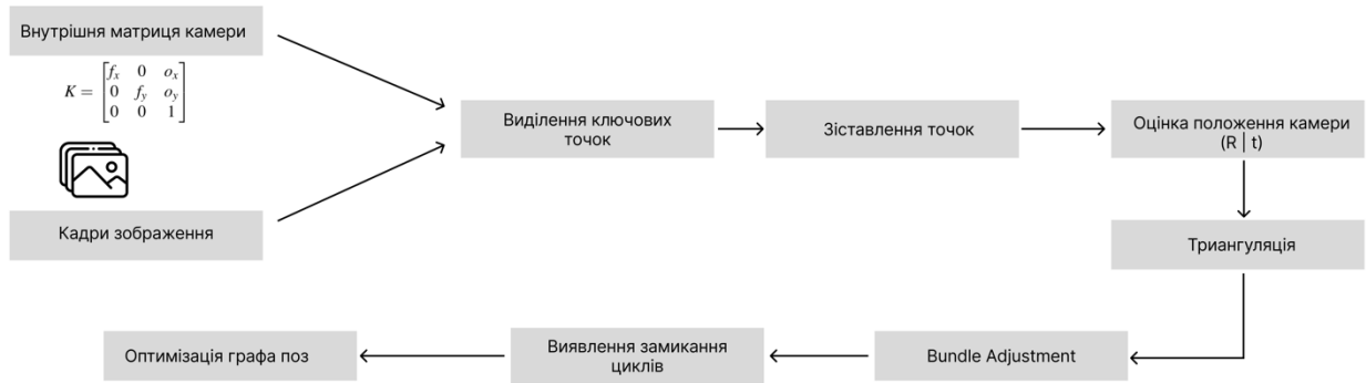
Рис. 3.2. Загальна схема роботи SLAM на основі оптимізації
