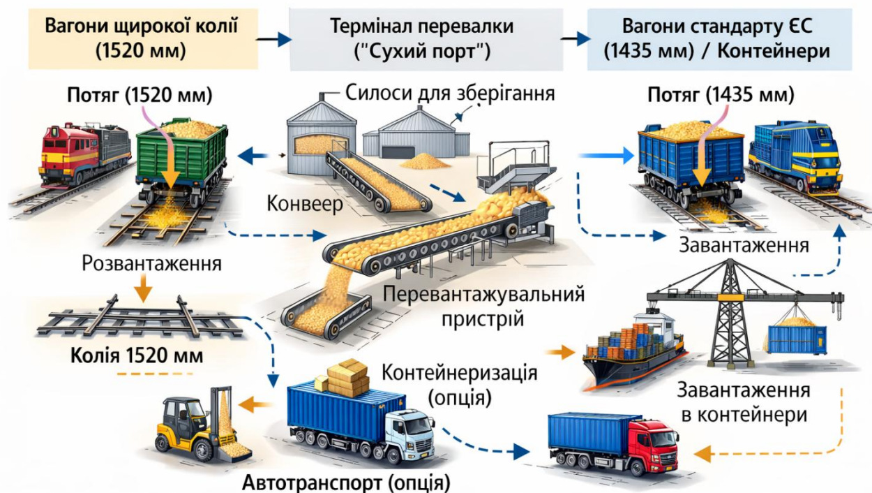
Рисунок 1.2. Технологічна схема інтермодальних операцій на залізничному прикордонному переході [3, 10]
