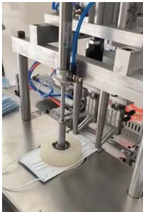
Рис.1.3. Зовнішній вигляд маніпулятора зварювання
