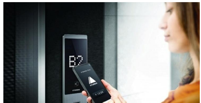
Рис. 1.4 – Виклики ліфтів за допомогою смартфона
