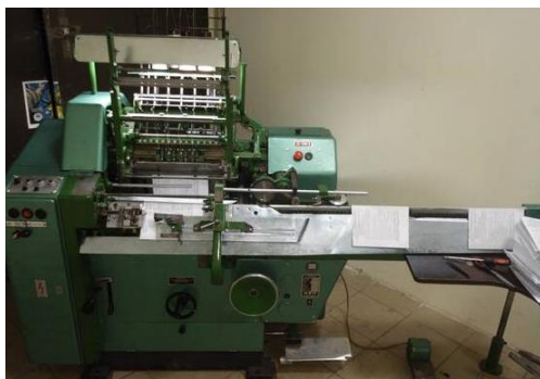
Рисунок 1.14 – Загальний вигляд ниткошвейної машини «Brehmer 381/3E» з самонакладною автоматичною машиною «Kolbus АН»
