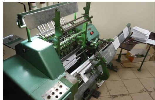
Рисунок 1.14 – Загальний вигляд ниткошвейної машини «Brehmer 381/3E» з самонакладною автоматичною машиною «Kolbus АН»
