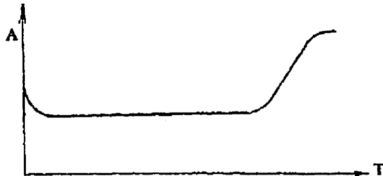
Рисунок 1.1 – Залежність рівня вібрацій від зміни макро- і мікрогеометрії деталей із напрацюванням: Т - час напрацювання; А – рівень
