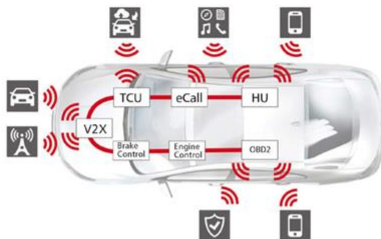
Рисунок. 4.1 - Основні системи зв'язку автомобіля
