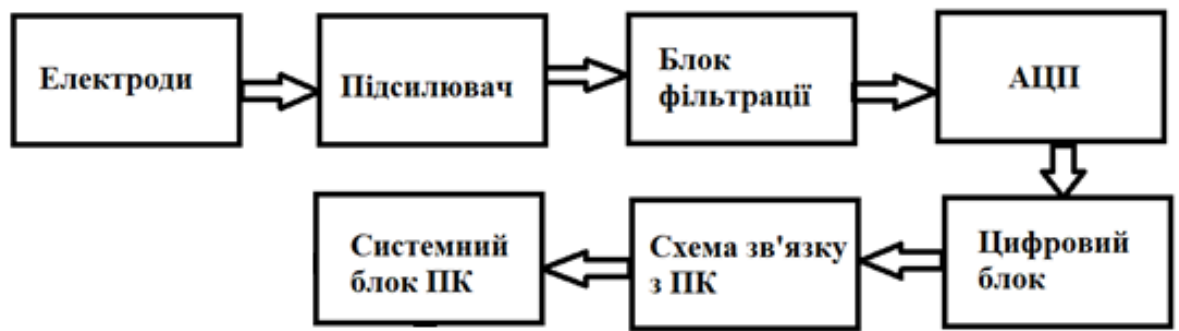
Рисунок 2.1.1 – Структурна схема електроенцефалографа
