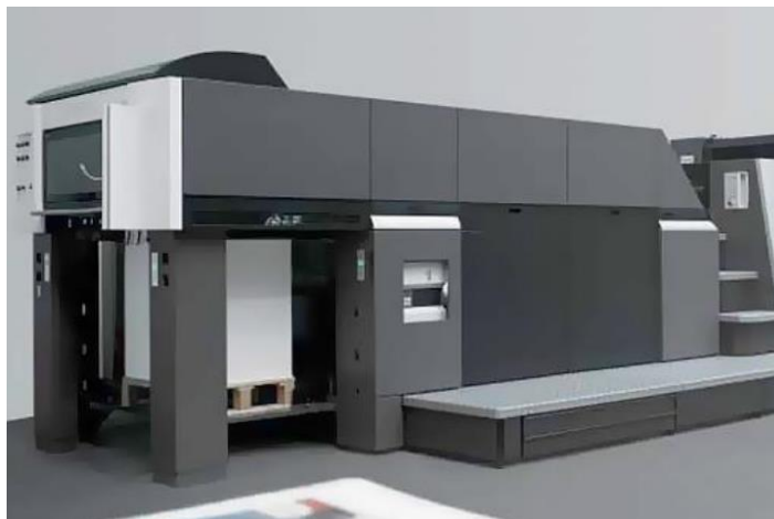
Рисунок 1.13. Подовжений приймальний пристрій Preset Plus (довжина подовження 160 см) машини Heidelberg CD-74.
