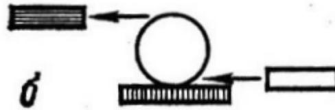
Рисунок 1.5. Схема виводу відбитків зі зворотним виводом.
