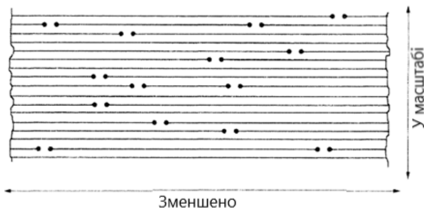
Рис. 7.15. Модель структури НВМПЕ мікрофібрили
