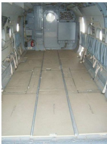
Рис. 24.3. Система бронювання гелікоптера MI-17 ВПС Пакистан, компанія Armour of America
