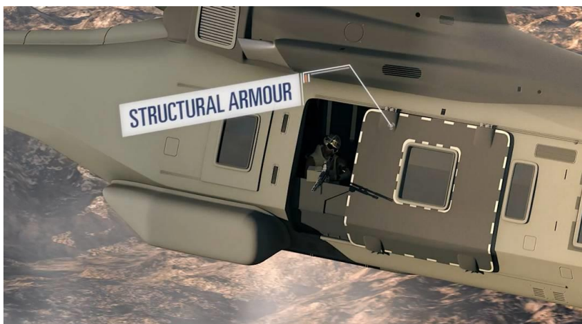
Рис. 24.4. Легка суцільна панель бічних дверей для захисту стрілка, компанія Ten Cate Advanced Armour
