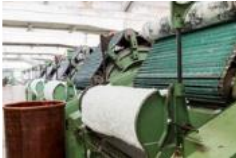
Рис. 9.4. Стандартна кардувальна машина з плоским верхом, яка має голкову конвеєрну стрічку
