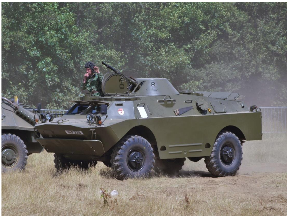
Рис. 23.3. Бойова розвідувально-дозорна машина БРДМ-2
