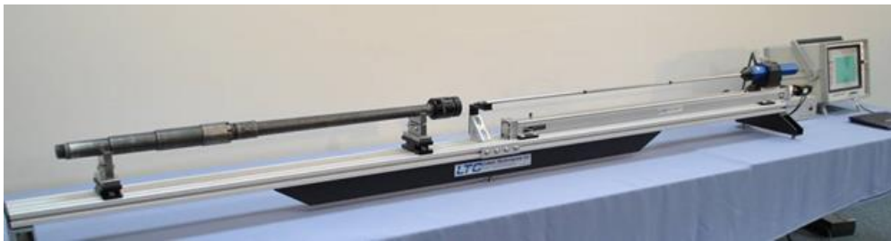
Рис. 25.7. Датчик BEMIS та моторизований ступінь подачі для перевірки ствола 50 калібру
