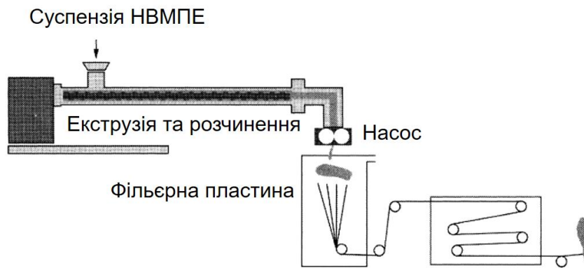
Рис. 7.11. Модель процесу гелюформування волокон
