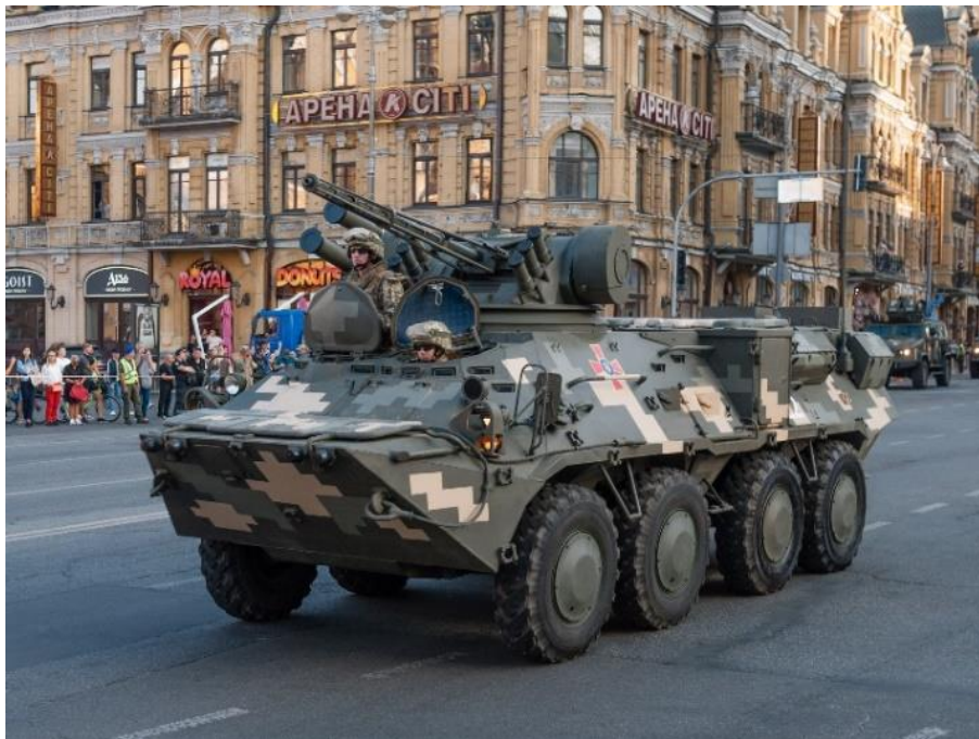
Рис. 32.13. Бронетранспортер десантний БТР-3
