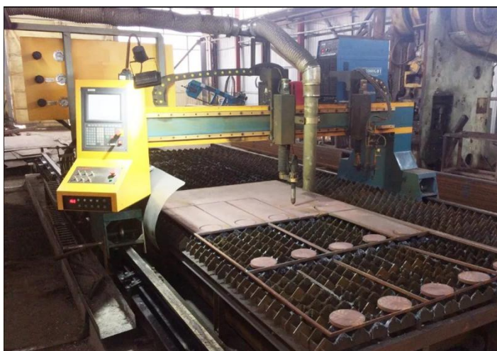
Рисунок 2.49 - Процес нарізання заготовок на станку ЧПУ [26]
