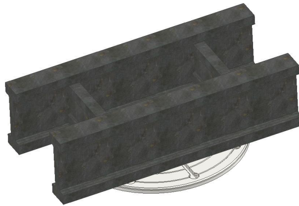
Рисунок 5.8 — Навантаження еквівалентне 150 кг для дослідження 2
