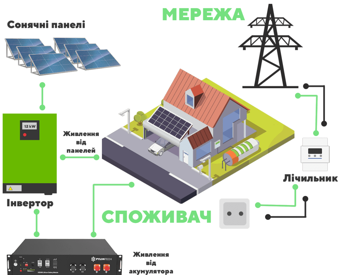
Рисунок 1.5 – Принципова схема резервної ФЕС [8]
