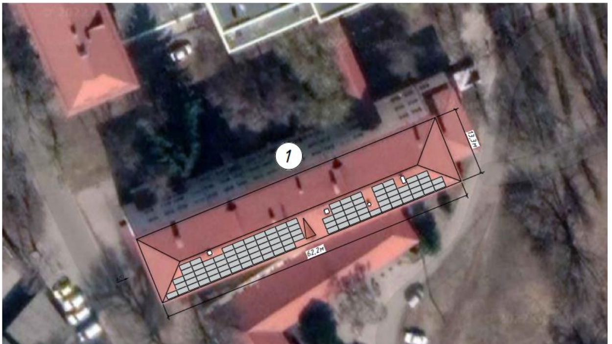
Рисунок 2.3 – Схема розташування фотоелектричних модулів на скатах дахів будівель
