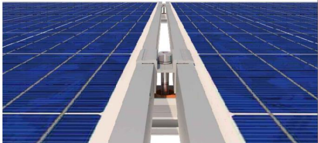
Рисунок 2.7 – кріплення Т прижимів [10]
