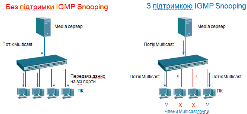
Рисунок 4.5 – Використання IGMP Snooping на локальному комутаторі
