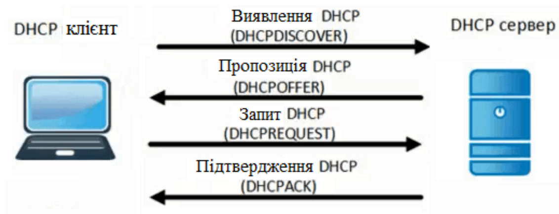
Рисунок 6.16 – Приклад взаємодії клієнта з DHCP-сервером
