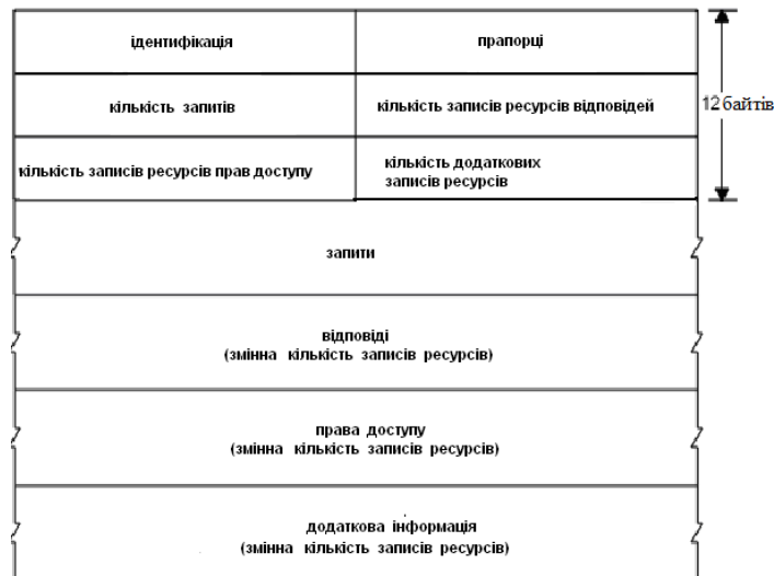
Рисунок 5.7 – Загальний формат DNS-запиту і DNS-відповіді
