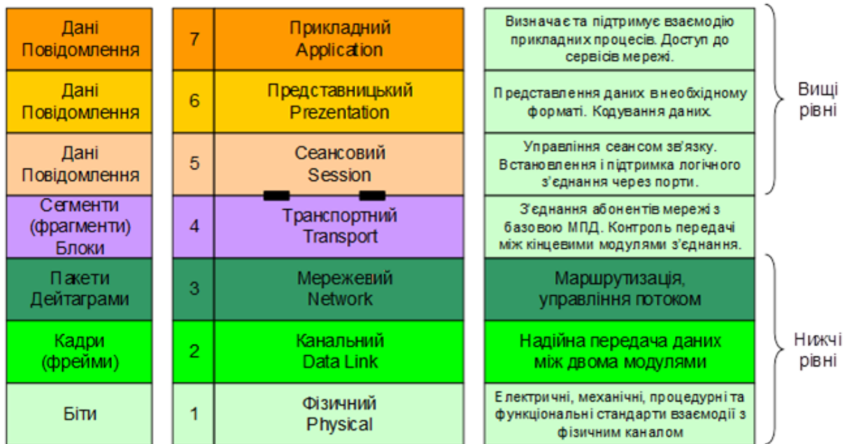
Рисунок 1.1 – Рівні моделі OSI
