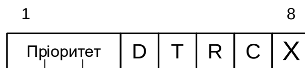
Рисунок 2.8 – Структура байту «Тип сервісу»
