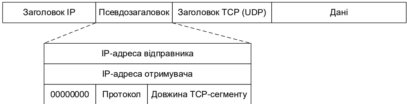
Рисунок 2.6 – Розташування псевдозаголовку та його структура
