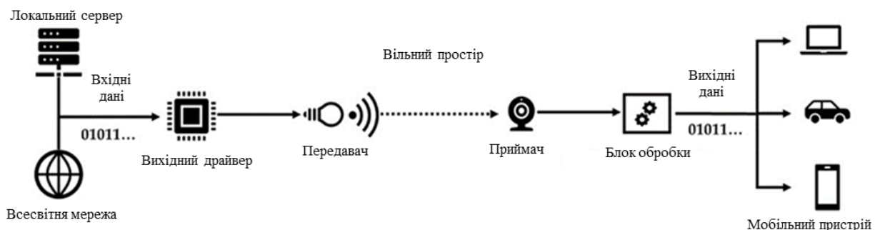
Рисунок 2.5 - Технічна реалізація низхідного каналу Li-Fi [29]
