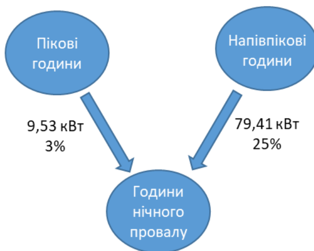
Рисунок 3.16 – Перенесення навантаження для рівномірної моделі
