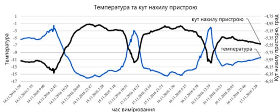
Рис.4.7 - Покази температури проводу і кута нахилу пристрою, встановленого на лінії напругою 110 кВ
