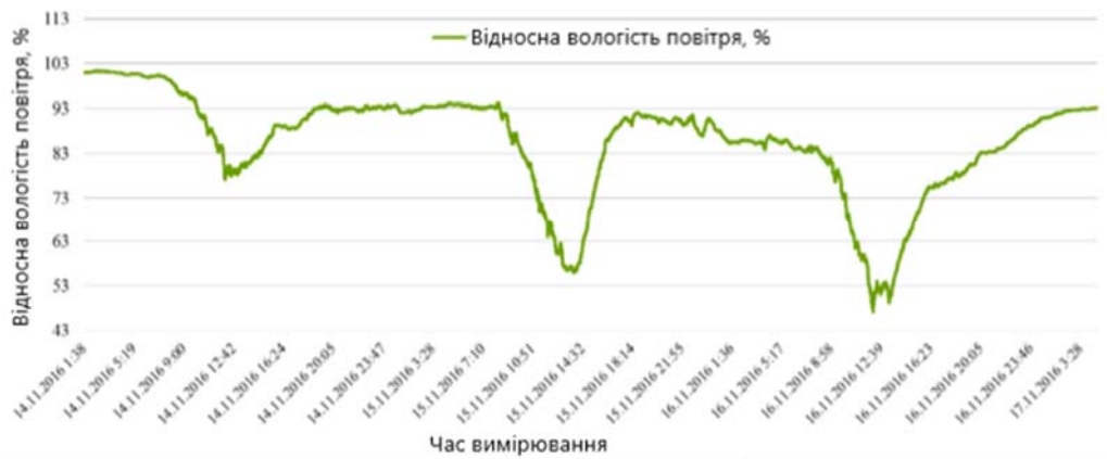
Рис.4.8 - Покази відносної вологості повітря з пристрою, встановленого на лінії напругою 110 кВ
