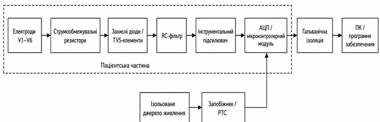
Рис.2.5 — Структура захисного контуру користувача автоматизованої системи кардіологічного моніторингу
