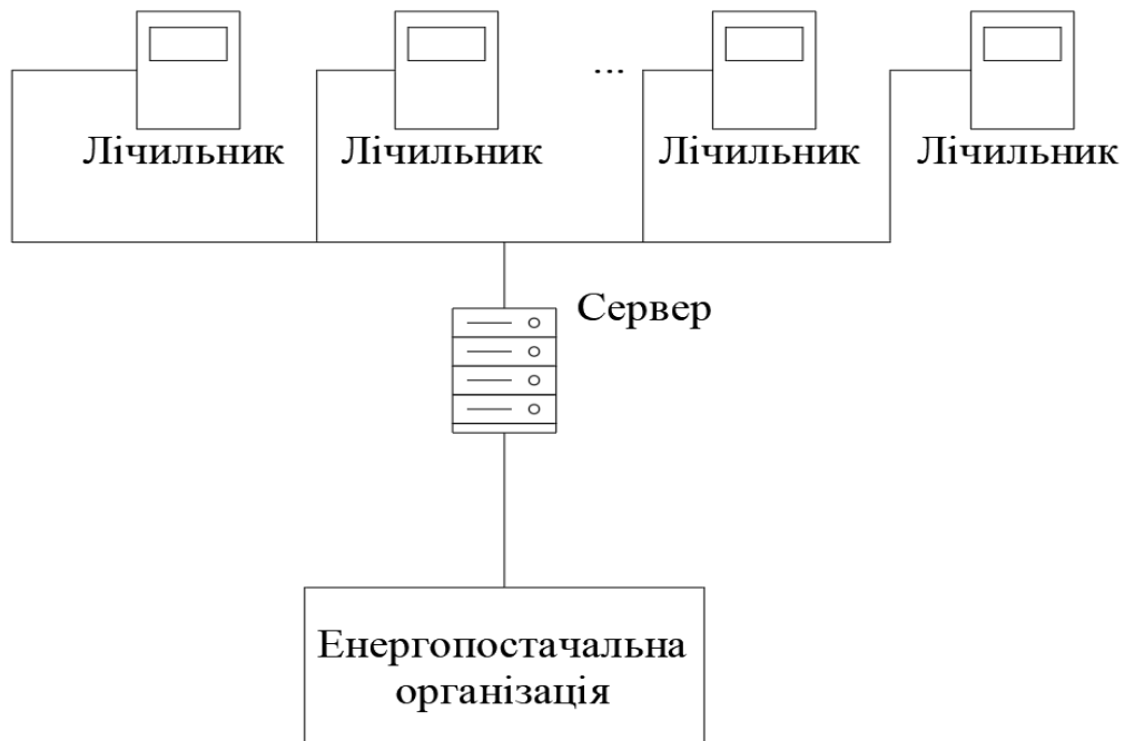
Рисунок 2.6 – Перший спосіб передачі даних АСКОЕ
