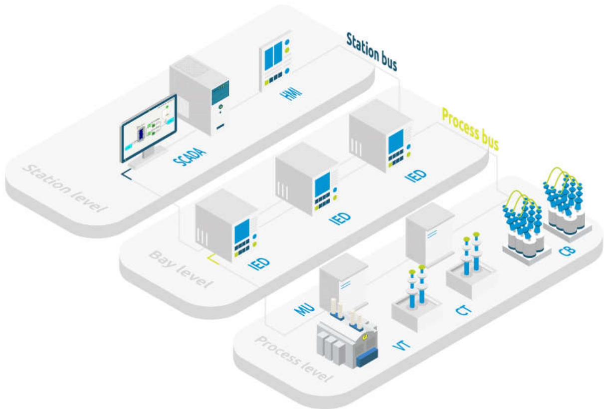
Рисунок 2.5 - Приклад архітектури IEC 61850
