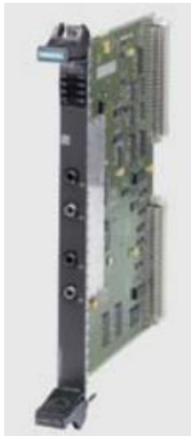
Рисунок 6.10 – Загальний вигляд комутаційного модуля CP53M0
