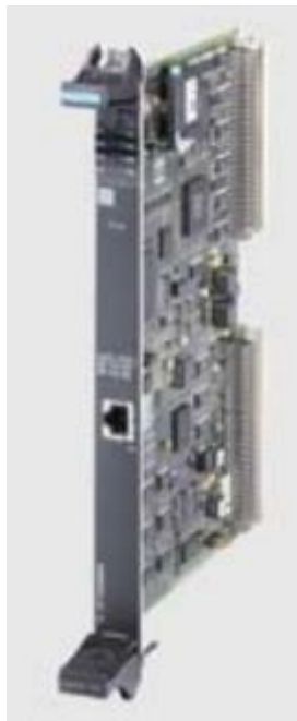
Рисунок 5.9 – Загальний вигляд комутаційного модуля CP51M1
