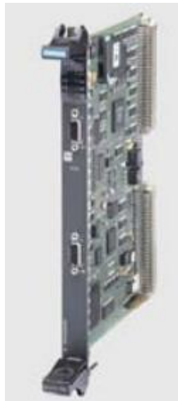
Рисунок 6.8 – Загальний вигляд комутаційного модуля CP50M1
