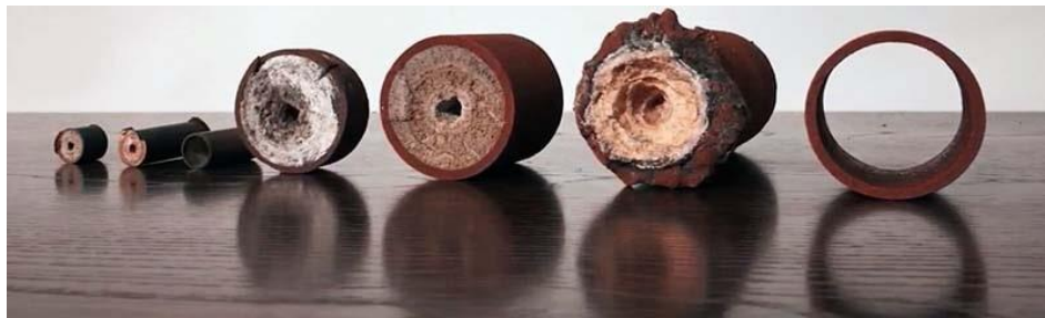
Рисунок 3.11 – Приклад накипу всередині металевих труб
