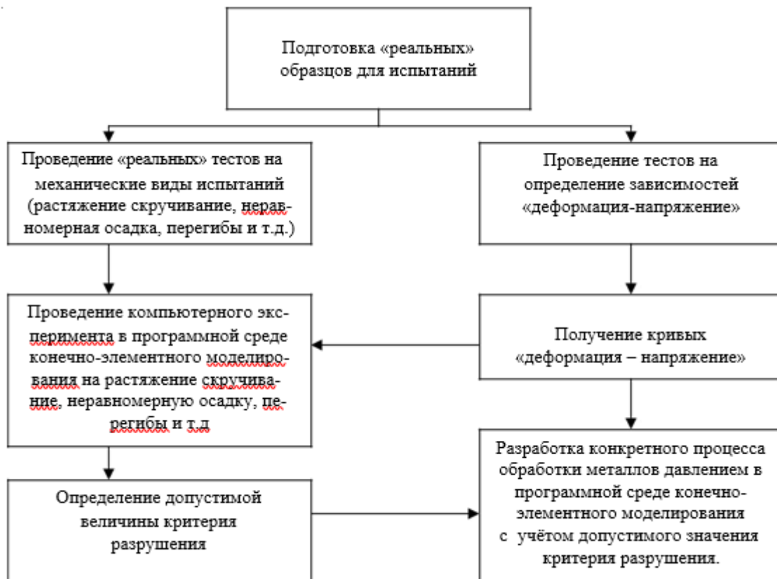
Рис. 3.7 Етапи перевірки зразків на руйнування
