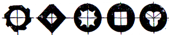
Рисунок 1.4 – Перерізи виробів, отриманих холодним видавлюванням
