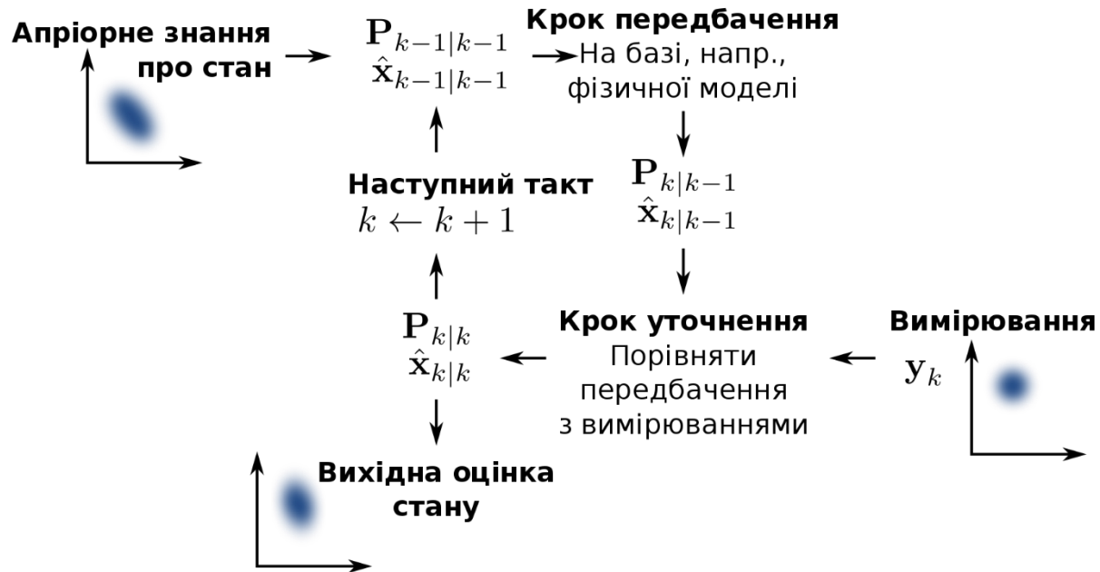
Рисунок 2.3.4 – Діаграма з основними кроками фільтрування Калмана: передбачення та уточнення
