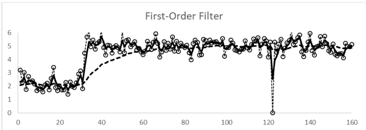
Рисунок 2.3.2 – Характеристика продуктивності фільтра першого порядку до зміни кроку процесу та стрибка
