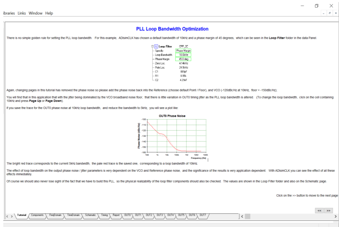
Рис. 3.22 – Оптимізація моделі кола зворотного зв'язку схеми ФАПЧ
