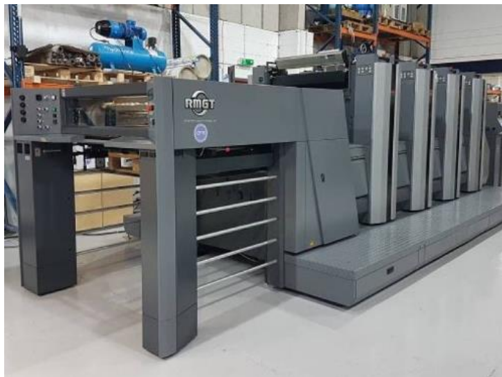
Рисунок 11 – Самонаклад друкарської машини RMGT 790.
