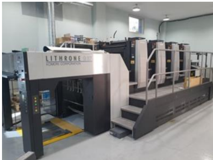
Рисунок 10 – Самонаклад друкарської машини Komori Lithrone G37.
