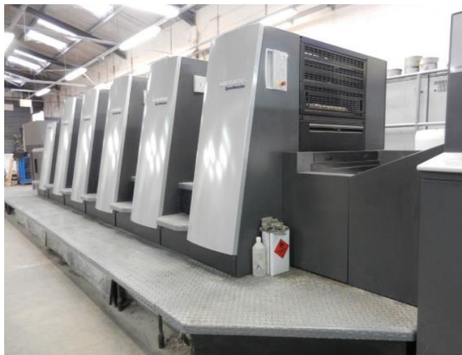
Рисунок 8 – Самонаклад друкарської машини Heidelberg Speedmaster XL 75.
