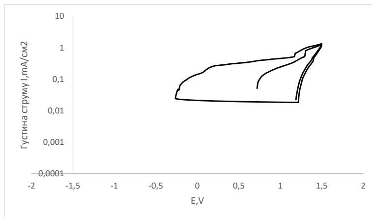
Рис.3.4 Циклічна поляризаційна крива в 0,5М сульфатної кислоти в метанолі
