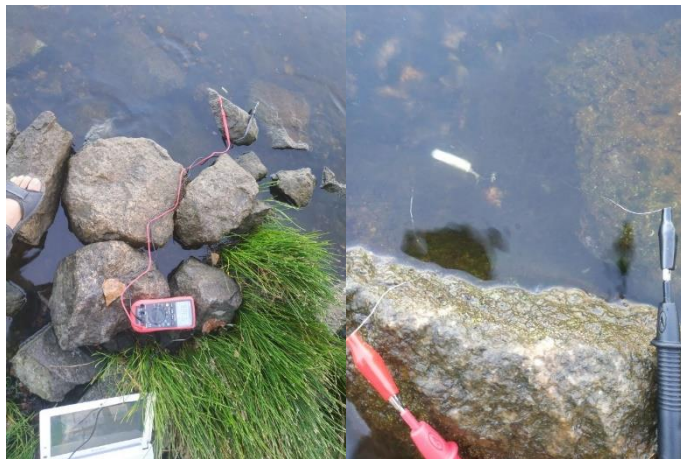
Рис. 2.2.2.8. Випробовування сенсора кисню з мембраною у затоці Наталка
