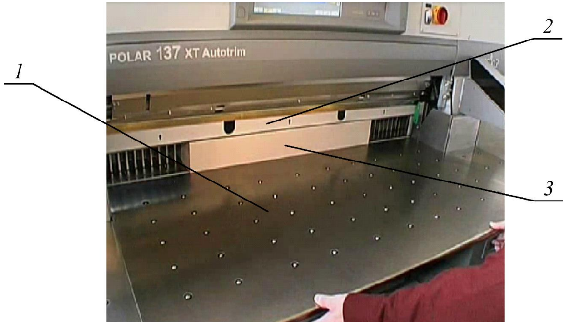
Рис. 2.1. Розташування виконавчих елементів механізму притиску
